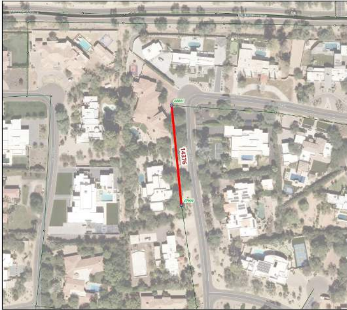
ID 14376 (Via Los Caballos & Ave. Del Sol) 298 LF of 8" VCP
